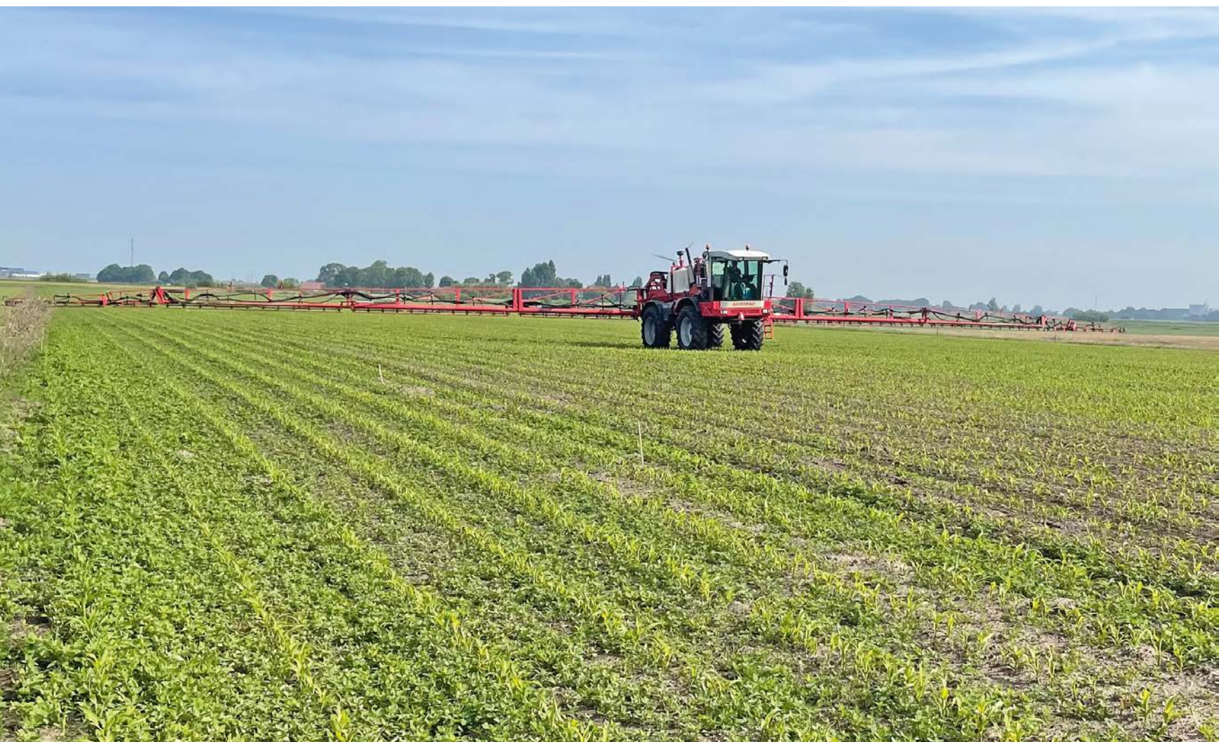
De Agrifac van loonbedrijf Buma in It Heidenskip voldoet nu nog aan 90 procent driftreductie. Het loonbedrijf neigt naar het upgraden van de spuit met een verlaagde spuitboom met een dopafstand van 25 centimeter en boomhoogtesensoren.
