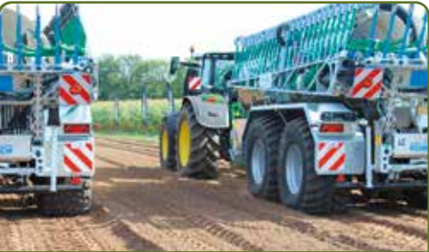
Links de nieuwe Flotation Optimall VF 750/60R30.5-band, die op 1,3 bar mag staan. Rechts de Flotation Trac, die op 1,6 bar moet blijven.
