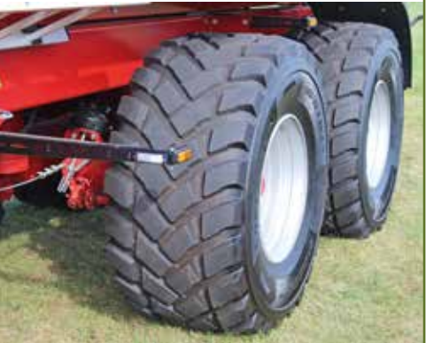
Ook bij de Endurion Trailer-band zijn de nokken gevormd naar het Traction+-concept.
