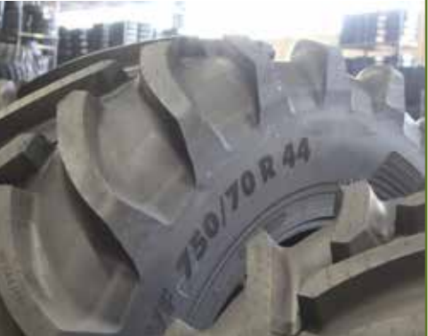
Een VF 750/70R44 van 2,20 meter hoog voor trekkers als de Claas Axion 900 en de Fendt 900-serie is op de Sima geïntroduceerd. Binnen twee jaar komen daar 46-inch-maten (2,30 meter hoog) bij.
