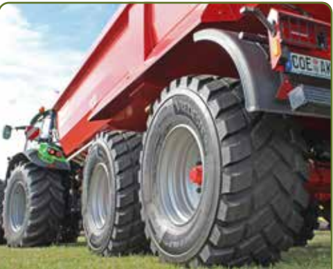
De Endurion Trailer-band kreeg een zwaarder karkas met een staalgordel en dikkere zijwanden tegen indringing van scherpe voorwerpen.
