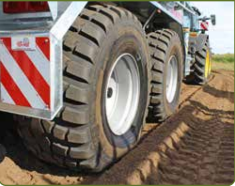
De Flotation Optimall VF gaf twaalf millimeter minder insporing en met een penetrometer gemeten, bleek ook de bodem zeven procent minder verdicht.
