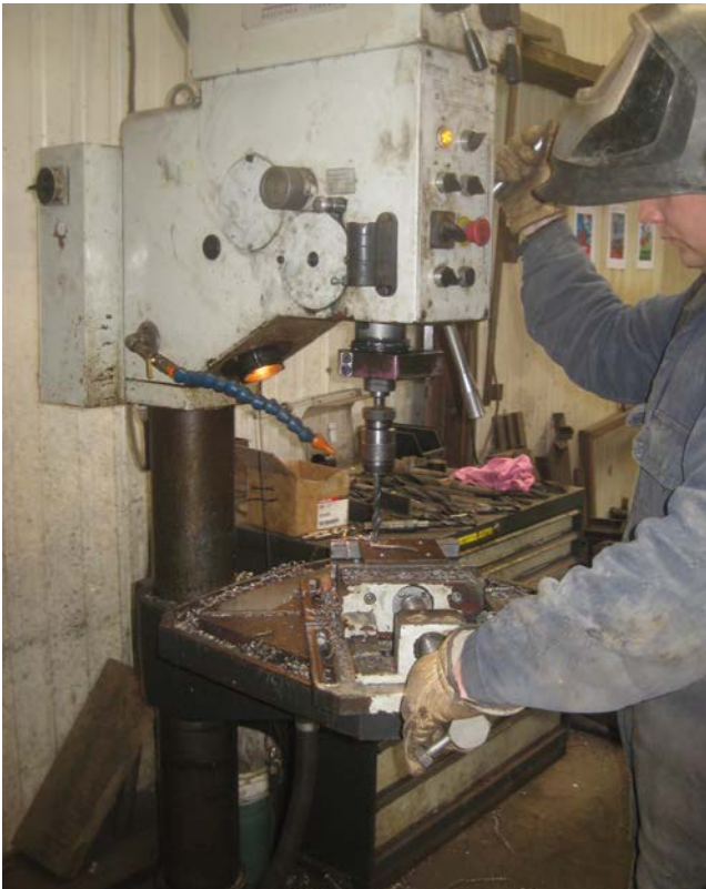
Gebruik geen handschoenen als je werkt met een kolomboor. De kans is aanwezig dat deze worden meegetrokken door de machine.
