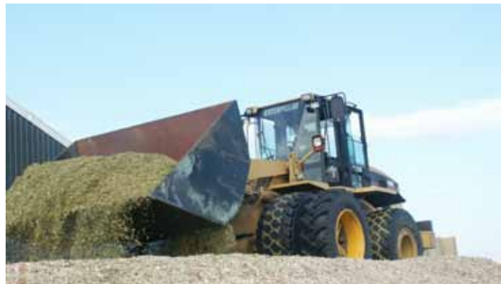
Gebruik bij het aanrijden van een kuilhoop een shovel of trekker met dubbellucht.
