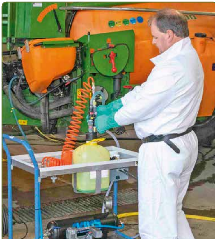
GoatThroat is een systeem dat op basis van een handpomp of kleine compressor middel uit de cans zuigt.
