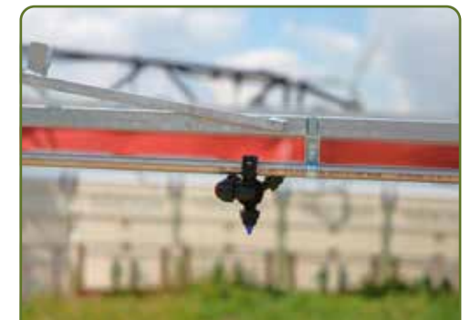
Van groot belang voor de goede werking van het systeem is een bespuiting met een geleidende vloeistof. De spuitmachine zit voor op de trekker.
