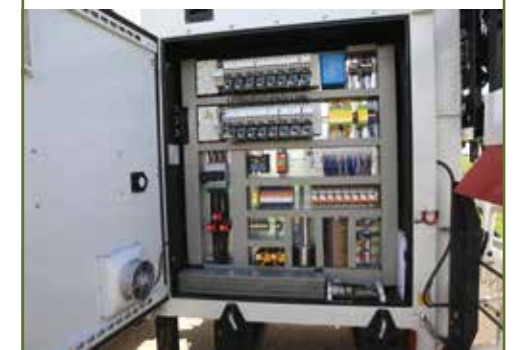
Het hart van de Volt.cube-generator. Deze wekt een spanning op tussen 2000 en 5500 volt.
