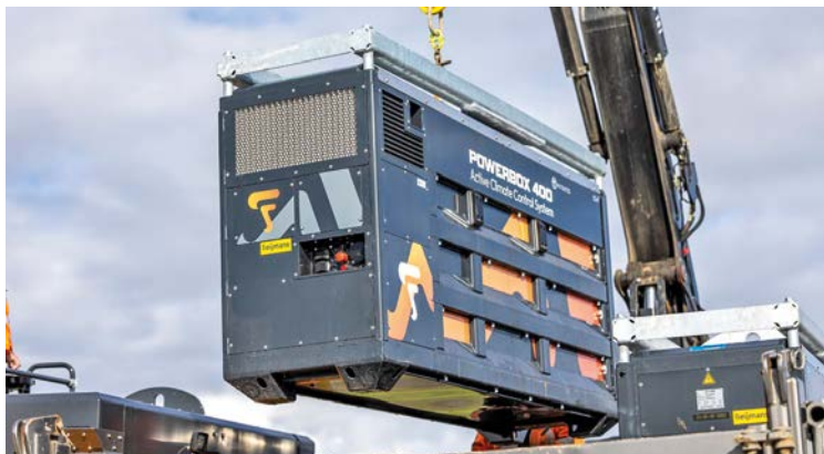
Batterijpakketten verwisselen is nodig als de laadcapaciteit ter plekke onvoldoende is of als er in 24-uurs-shifts wordt gedraaid. De aanschaf van een extra Powerbox en de bijbehorende logistiek zijn kostprijsverhogend.
